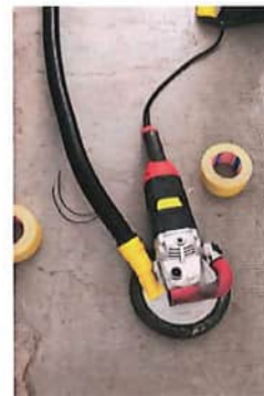
4 Von Hand geführter Winkelschleifer mit Quellenabsaugung
