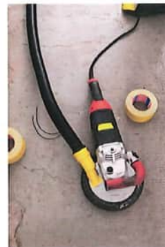
4 Von Hand geführter Winkelschleifer mit Quellenabsaugung
