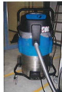
2 Industriestaubsauger mit Filter für Staubklasse H (Asbest)
