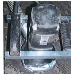
5 Schleifmaschine mit Direktabsaugung
