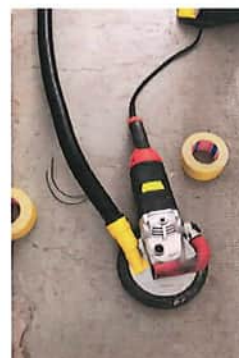
4 Von Hand geführter Winkelschleifer mit Quellenabsaugung
