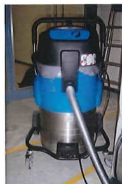
2 Industriestaubsauger mit Filter für Staubklasse H (Asbest)
