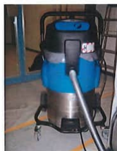
2 Industriestaubsauger mit Filter für Staubklasse H (Asbest)
